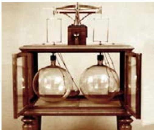
Весы, сконструированные Д.И.Менделеевым для взвешивания газообразных и твердых веществ Scales designed by Dmitri Mendeleev to measure gaseous and solid substances
